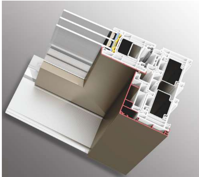
Nodo laterale fisso Minimal.
