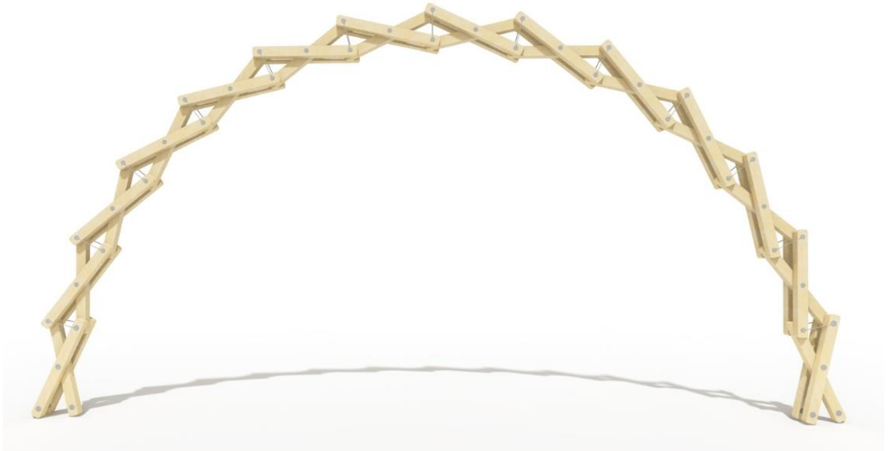
Figura 2.1 Inquadramento arco portante raggio esterno 8m
