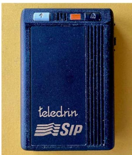
Il cercapersone della Motorola "Teledrin", gestito e commercializzato dalla rete SIP, nel 1980 ha rivoluzionato la possibilità di essere reperibili con una copertura ampia in buona parte della nostra penisola. Piccolo come un pacchetto di caramelle e alimentato semplicemente con una normale pila stilo AA da 1,5 V, senza la ricarica che a quei tempi non era quasi mai prevista.
