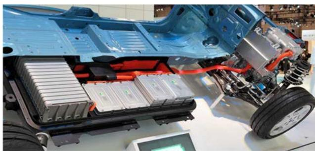
Posizionamento del pacchetto batterie sotto l'abitacolo in un moderno veicolo elettrico.
