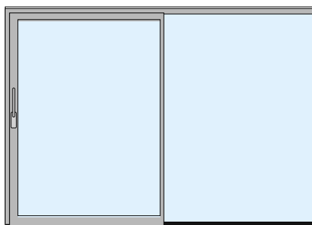
Un'anta apribile e una fissa Minimal effetto tutto vetro per aumentare la superficie vetrata e la luminosità dell'infisso.
