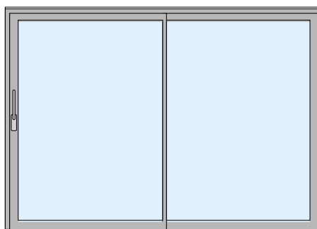
Un'anta apribile e una fissa Simmetrica con le stesse dimensioni dell'anta mobile.
