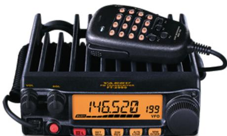
L'FT-2980E eroga una potenza di 80 watt! Nessuna ventola di raffreddamento necessaria, un display enorme e di facile lettura e la funzionalità di accesso tramite collegamento a Internet WIRES™ one-touch sono le peculiarità di questo nuovo ricetrasmittitore.
