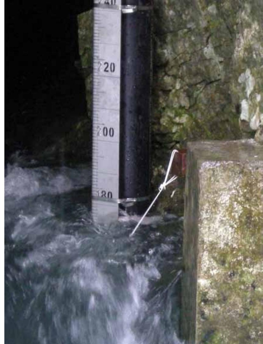
*Posizionamento dell'asta idrometrica alla sorgente del Frigido a Forno, foto di D. Magnani.*
