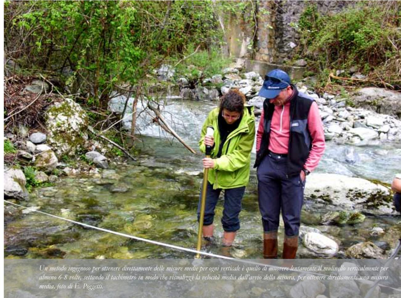
*Un metodo ingegnoso per ottenere direttamente delle misure medie per ogni verticale è quello di muovere lentamente il mulinello verticalmente per almeno 6-8 volte, settando il tachimetro in modo che visualizzi la velocità media dall'avvio della misura, per ottenere direttamente una misura media, foto di E. Poggetti.*
