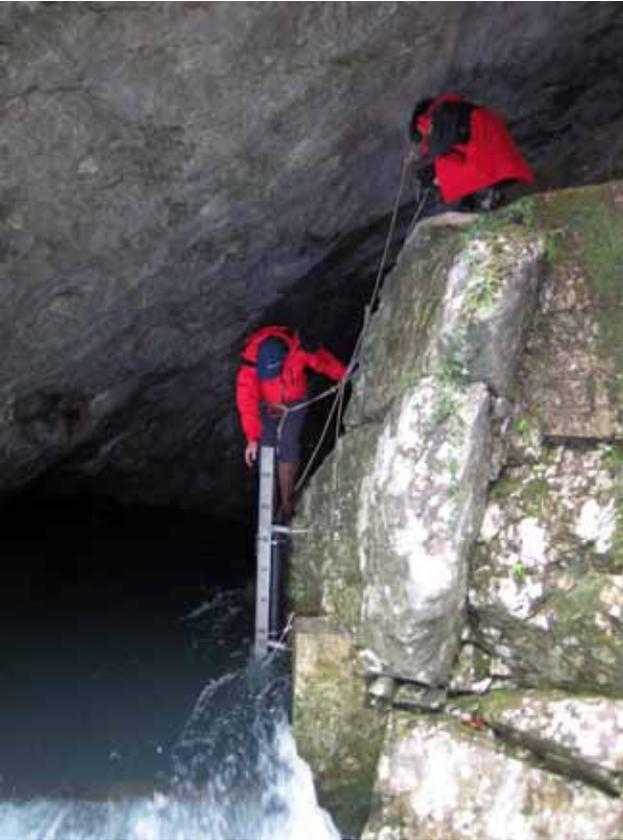
*Il posizionamento della sonda multiparametrica alla sorgente della Pollaccia ha richiesto di lavorare assicurati, per non rischiare di cadere in acqua, foto di V. Malcapì.*
