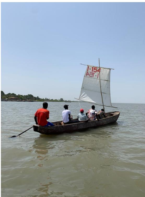
Le prove in mare sono state effettuate con poco vento ma hanno permesso di spingere con una vela al terzo di 5.5 metri quadri una piroga di 7 metri con 5 persone a bordo per un dislocamento complessivo prossimo agli 800 chili, evidenziando - pur con armi velici inadeguati, le mastre posizionate troppo a prua, la mancanza di una caricabasso del boma, e l'assenza di deriva e di timone (si usa una pagaia) , una buona attitudine a navigare anche al traverso.
